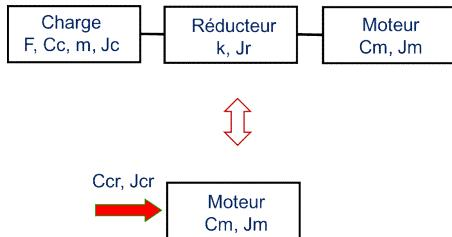
L'automatique, l'électricien ou le thermicien n'ont pas nécessairement à connaître en détail la mécanique du système. Pour conduire une étude il peut être suffisant de connaître les caractéristiques de la charge observées depuis l'actionneur.
